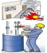
自然発火性物質の運搬用容器の洗浄作業において、洗浄液(有機溶剤)を液送する前に容器内を窒素置換するため、容器の1次側ノズルに窒素ノズルを接続し、バルブを開放したところ、容器2次側のバルブ接続部から内容物質が漏れ出し、自然発火により燃え、火災が発生した。
